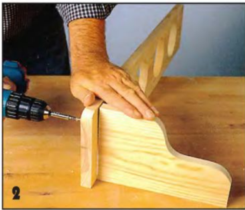
Предварительно нанеся клей на детали в местах их соединения, крепят верхнюю крышку к боковинам саморезами.
