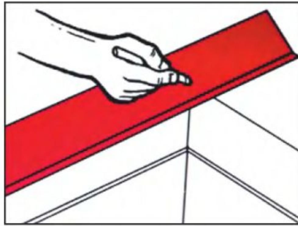
Рис. 13. Торцевые планки должны перекрывать верхний гребень.
