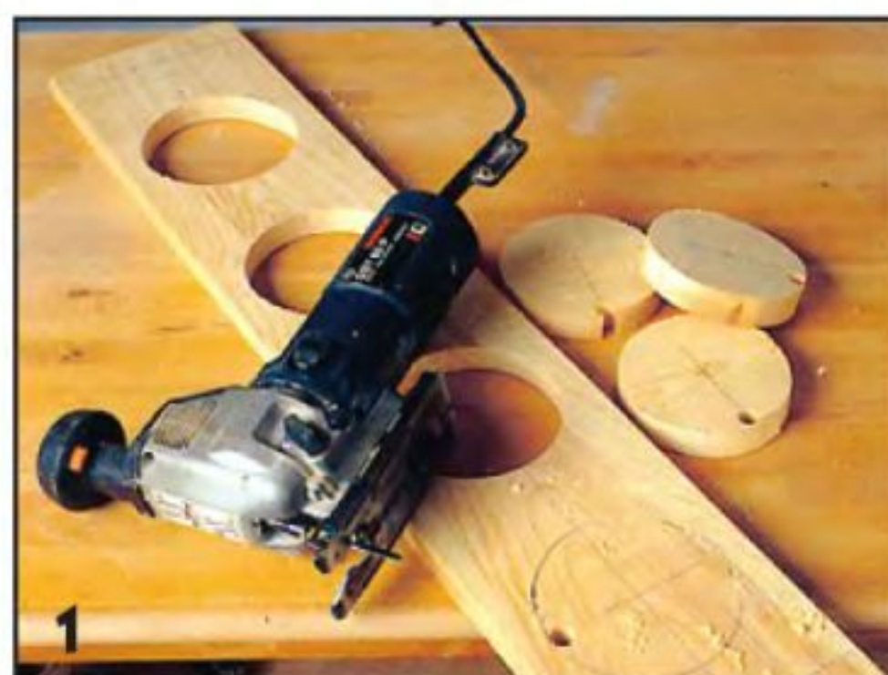
Сделав разметку на заготовке для верхней крышки и просверлив отверстия под пилку электролобзика, выпиливают гнезда под цветочные горшки.
