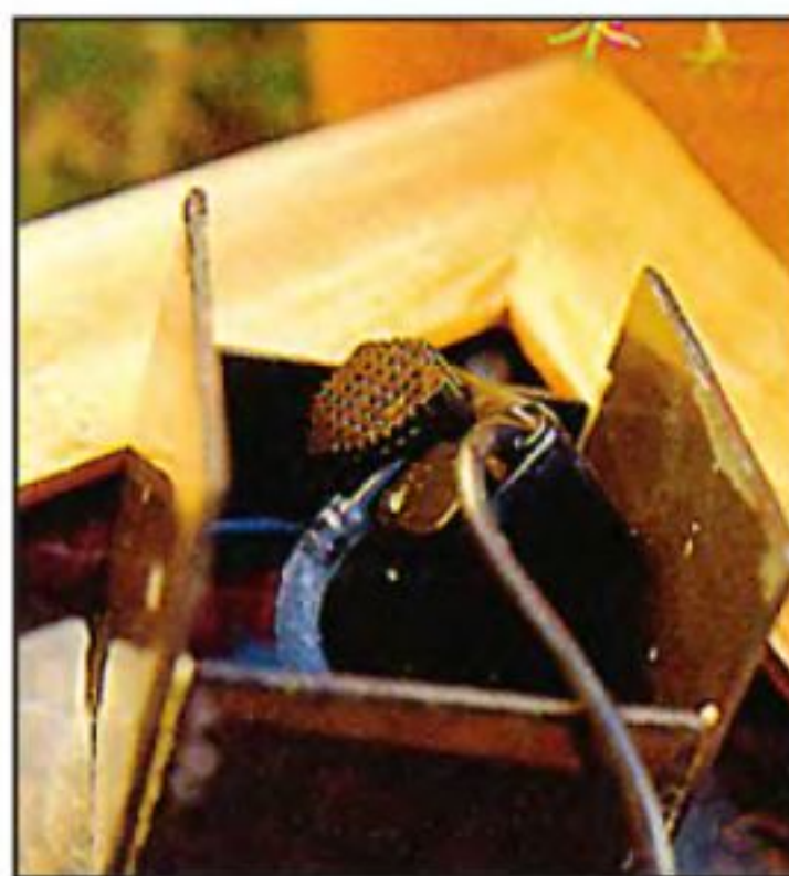
Насос с регулируемым расходом спрятан в коробке, склеенной из сланцевых плиток.
