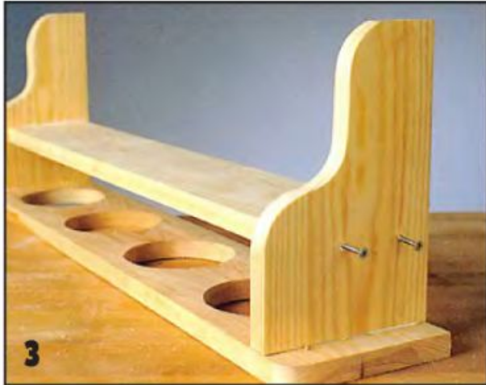
Таким же способом монтируют и опорную перемычку между боковинами.
