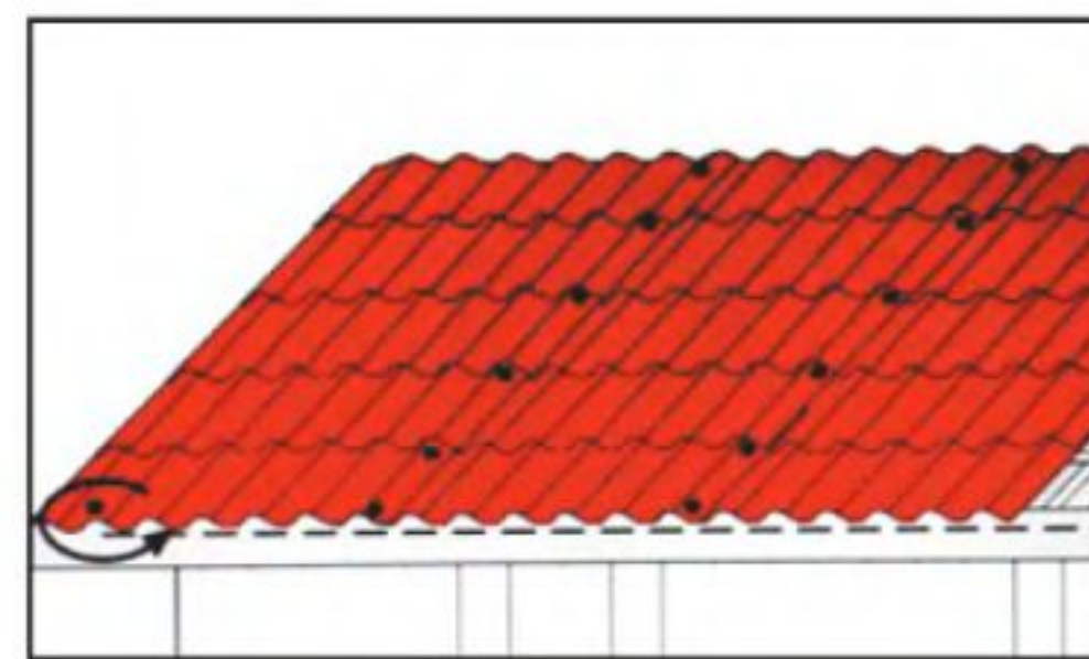
Рис.10. Блок из трёх скреплённых листов металлочерепицы выравнивают по линии карниза, поворачивая вокруг одного нижнего специально для этого оставленного технологического самореза, вкрученного в обрешётку.
