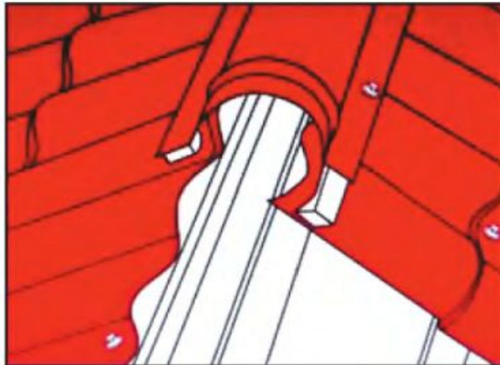
Рис. 14. Сверху устанавливают коньковые планки, которые крепят саморезами сквозь уплотнительную подкладку к кровельным листам.
