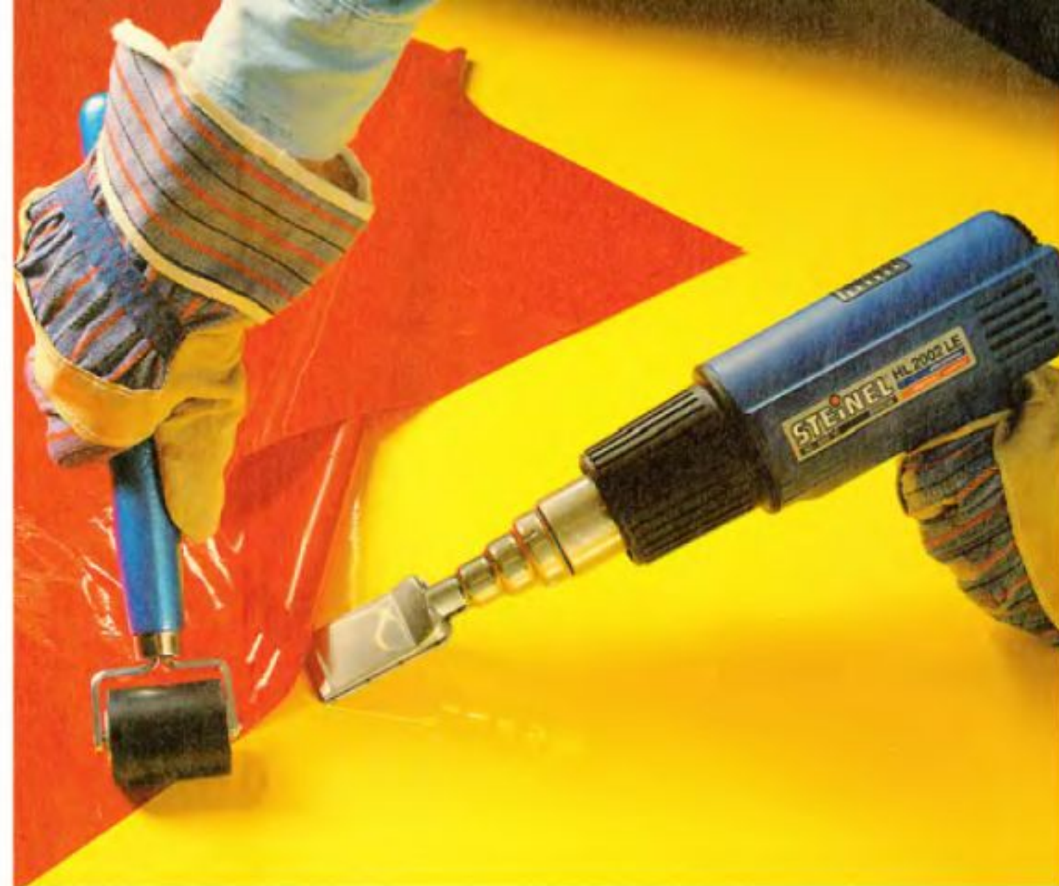
С помощью строительного фена (здесь — с плоской насадкой) можно соединять сваркой относительно тонкие синтетические плёнки.
